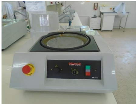
Figure II.1. Schéma d'une polisseuse métallographique
