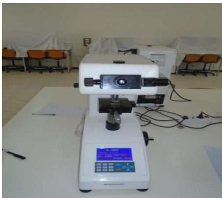
Figure II.3. Schéma du Microduromètre Vickers
