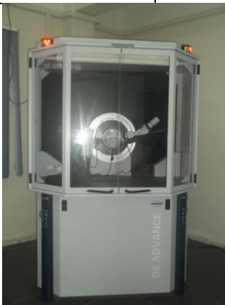
Figure II.4. Schéma du diffractomètre
