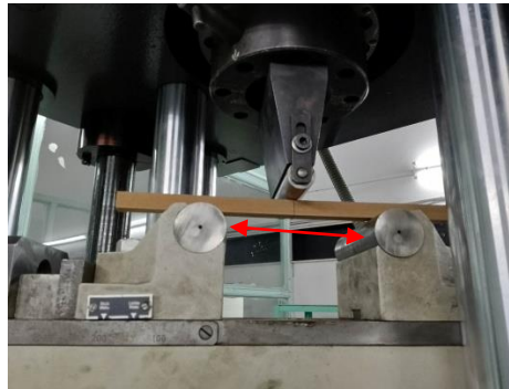
Fig.28, Machine universelle de flexion MFL de type VHP 600 de marque Zwick
