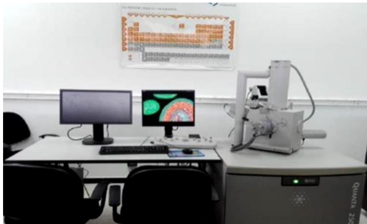
Fig.26, Microscope électronique à balayage (MEB) modèle FEI Quanta 250
