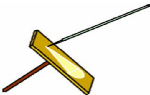
Fig.14, Schéma du dispositif de l'essai d'absorption de la surface.
