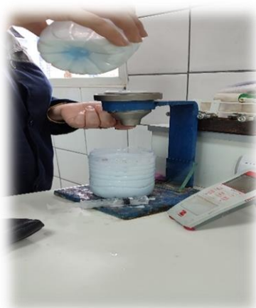
Fig.21, Le remplissage de l'entonnoir avec de la colle (la résine).
