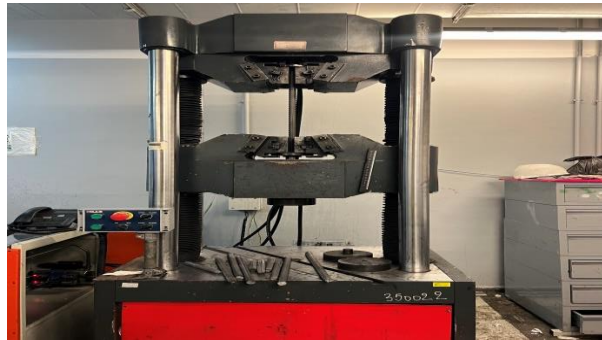
Fig. III.10. Machine de traction au niveau de l'entreprise AQS.
