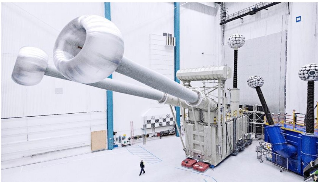
Figure 3-11: Vue d'un transformateur HVDC de 1100 kV (constructeur ABB)
