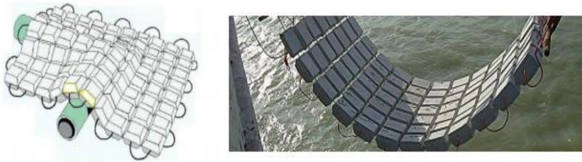
Figure 2-11 :Matelas en béton
