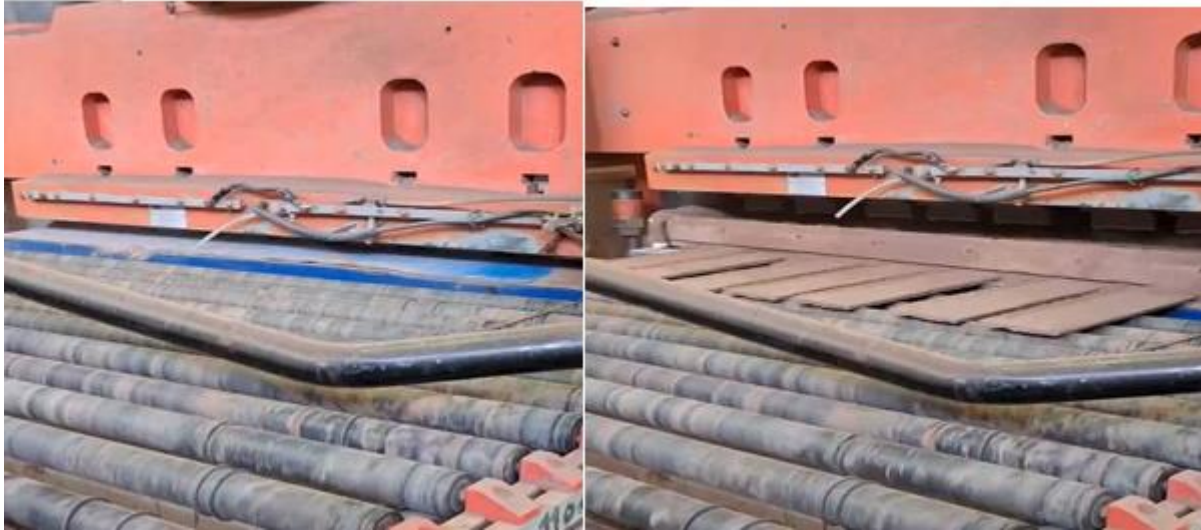
Figure 4. Pressage de la poudre et formation des carreaux céramiques.
