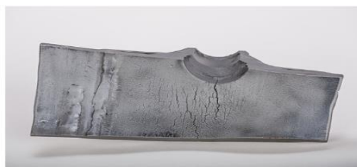
Figure 4 : Corrosion sous contrainte en milieu marin
