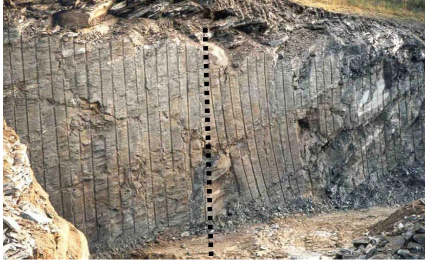
Figure 1.3. Déviation naturelle des forages causée par les strates du terrain (à gauche :avec tige guide pour limiter les déviations ; à droite : sans tige guide) D'après Meyer,2002
