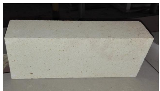
Figure V.11 : Réfractaires électrofondus d'alumine
