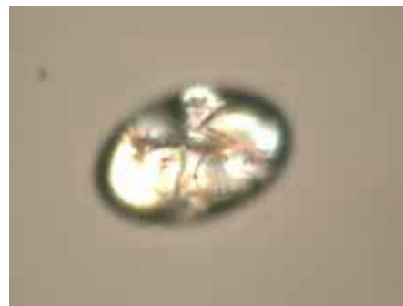
Figure 13: Bulle de soude de sulfate sous lumière orthogonale(x 100).
