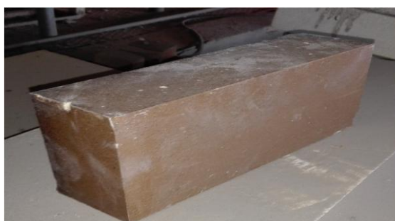
Figure V.10: Réfractaires électrofondus type AZS
