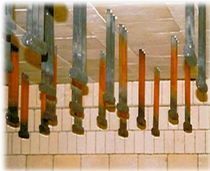
Figure III.4: Résistances électriques du bain d'étain.
