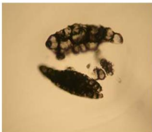
Figure 18: Pierre de corindon granulaire de nature Al-Si(x 100).
