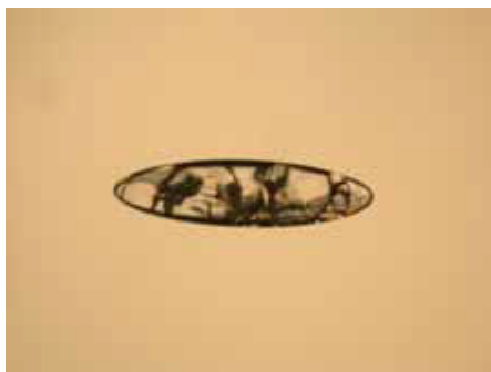
Figure 12: Bulle de soude de sulfate(x 100).
