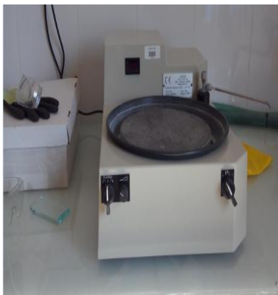
Figure 3: Polisseuse pour la préparation des échantillons.
