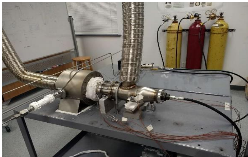
Figure I-20: Banc d'essai du flux thermique de la tête de chauffe [27].
