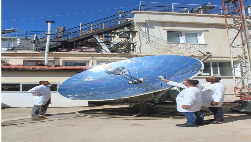
Figure I-7: Modèle de concentrateur avec moteur Stirling développé par CDER dz.
