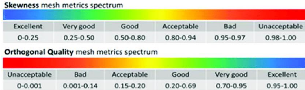
Figure II-6: Spectre métrique de qualité orthogonale et d'inclinaison des éléments de maillage.
