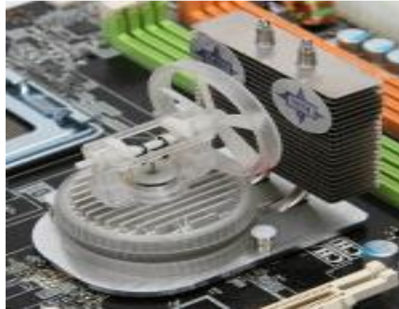
Figure I-12: Système de refroidissement de micro-processeur MSI.
