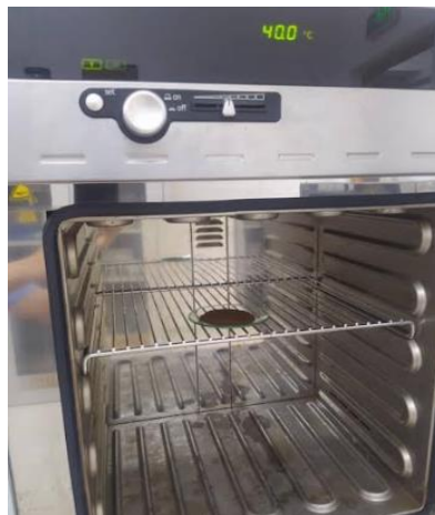
Figure III.2 : L'échantillon de MC dans l'étuve à 40°C.
