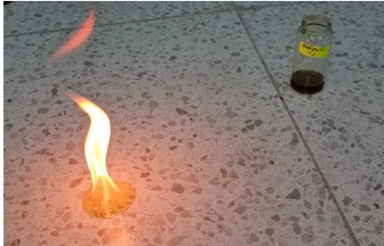
Figure IV.2 : Test d'inflammabilité du biodiesel extrait du marc de café
