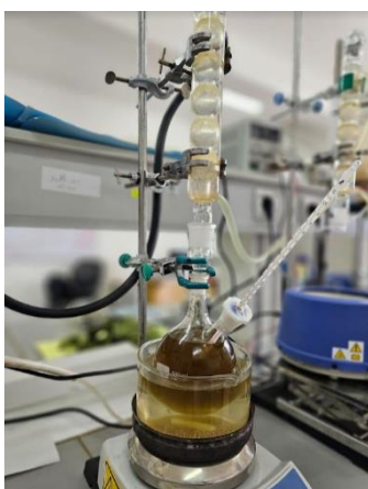
Figure III.4 : L'étape de la réaction de transestérification
