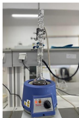
Figure III.3 : Extraction par décoction (A : Représentation schématique ; B : Montage de l'appareil au laboratoire)
