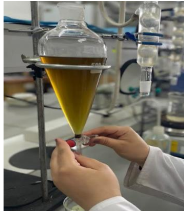
Figure III.5 : L'étape de la décantation du glycérol
