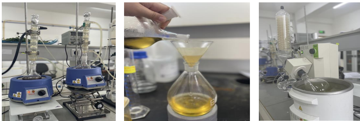
Figure III.7 : Les étapes de la réaction de transestérification directe, filtration et évaporation dans le rotavapeur.
