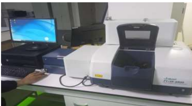
Fig . II.13 : Spectroscopie infrarouge à transformée de Fourier (FTIR) de type Jasco FT/IR-6800
