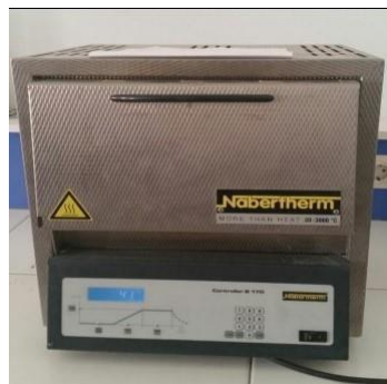
Figure 3.12. Four de traitement thermique
