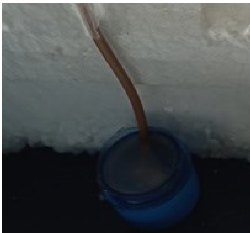
Figure 9 enrobage de l'acier ordinaire A283 GR C avec fil électrique.
