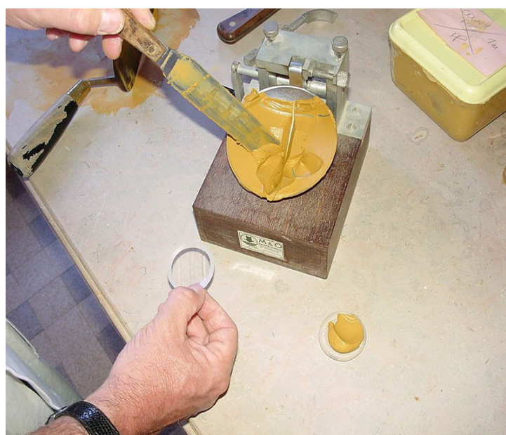
Figure 4.6: Limite de liquidité avec l'appareil de Casagrande.
