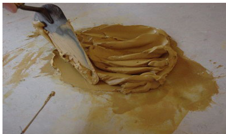
Figure 4.5: homogénéisation de la pâte par malaxage.
