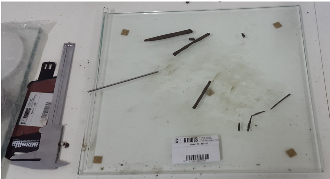
Figure 4.7 : Détermination de limite de plasticité.
