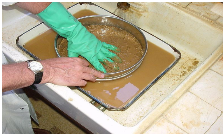
Figure 4.3 : récupération de la fraction 0/400 \mu\text{m} et décantation du mélange.
