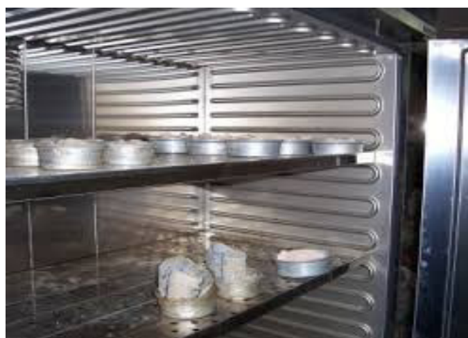
Figure 4.4 : séchage dans l'étuve avec température 65°C.
