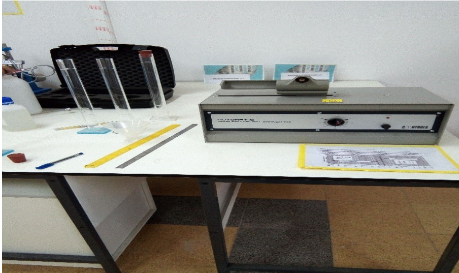
Figure 14 : les équipements pour mesurer l'équivalent de sable.
