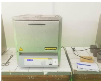
Figure I.6. Le four utilisé pour le changement cyclique les échantillons composites en PEHD/noir de carbone.
