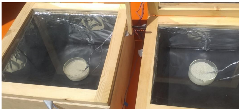
Figure 4.4 : Comparaison entre le cuiseur solaire standard et optimisé.
