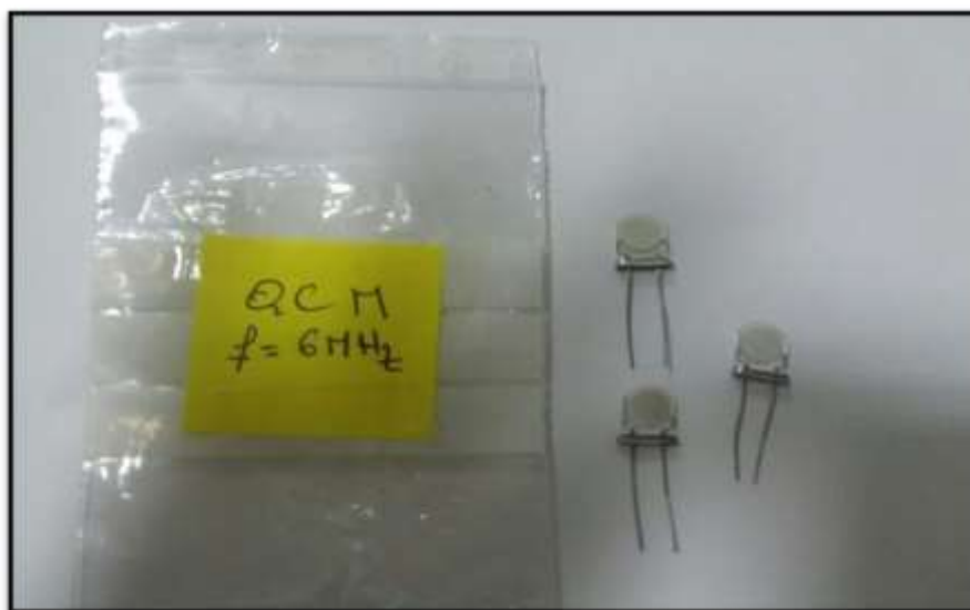
Figure II. 4: Photo du composant résonateur quartz après extraction de son boîtier
