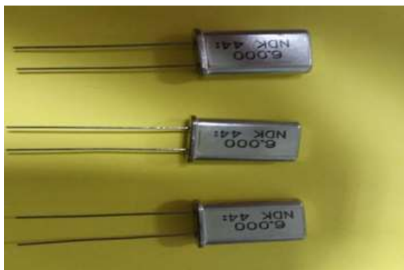
Figure II. 3: Les résonateurs à quartz utilisés dans notre expérience
