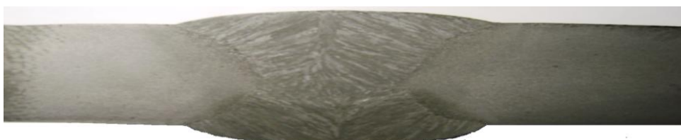
Figure V.14 : Macrographie des différents zones du cordon de soudure
