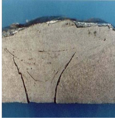
Figure II.6 : fissure à froid
