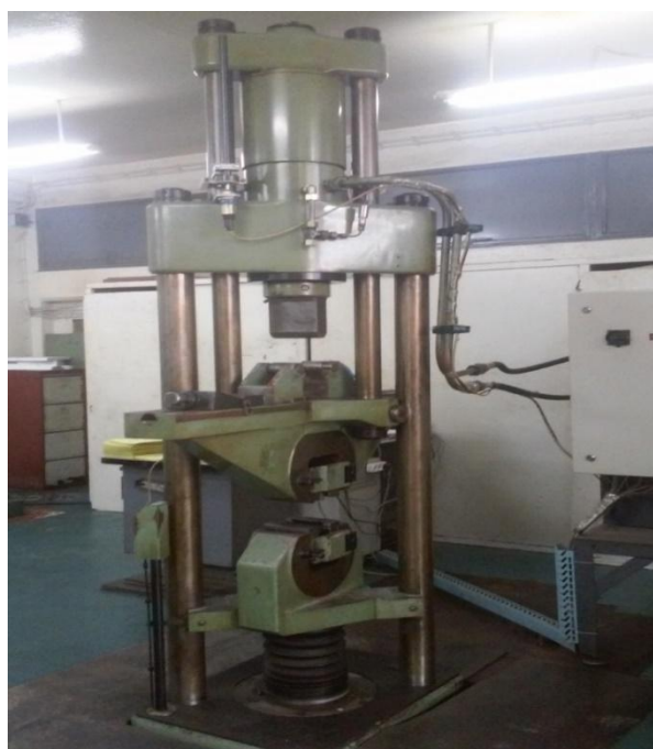
Figure IV.8 : Machine de l'essai de pliage(machine universel)
