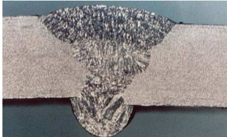
Figure II.12 : effondrement et excès de pénétration
