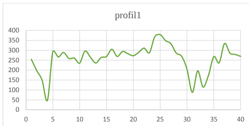
Figure V.8 : Courbe de variation des valeurs de microdureté Vickers sur les points de mesure du premier profil
