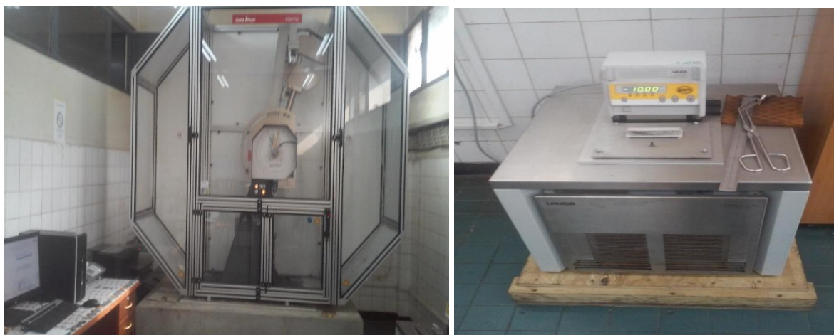
Figure IV.10 : Machine de l'essai de résilience avec l'enceinte thermique
