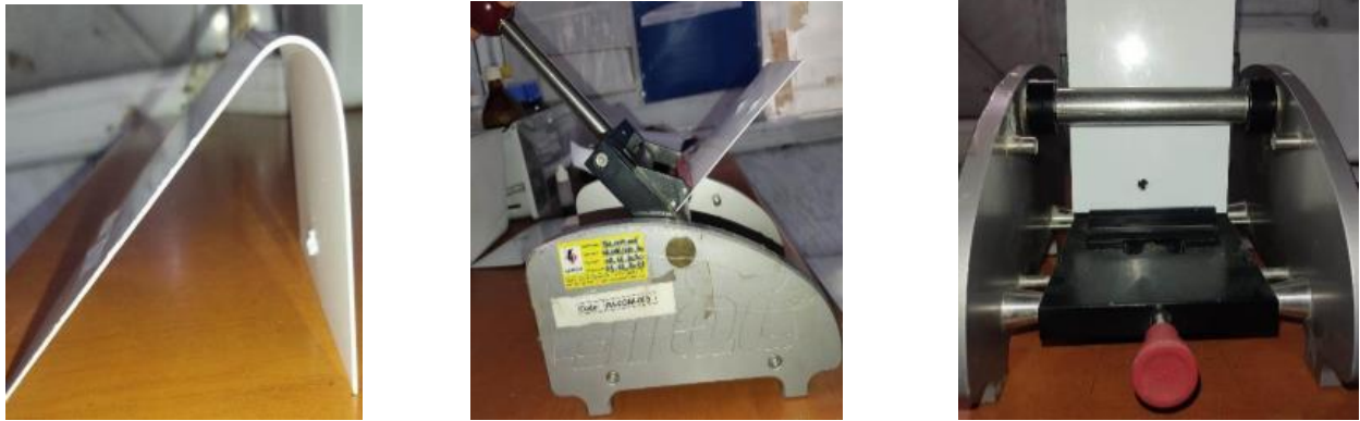
Figure 39: Pièce subit à un test de pliage
