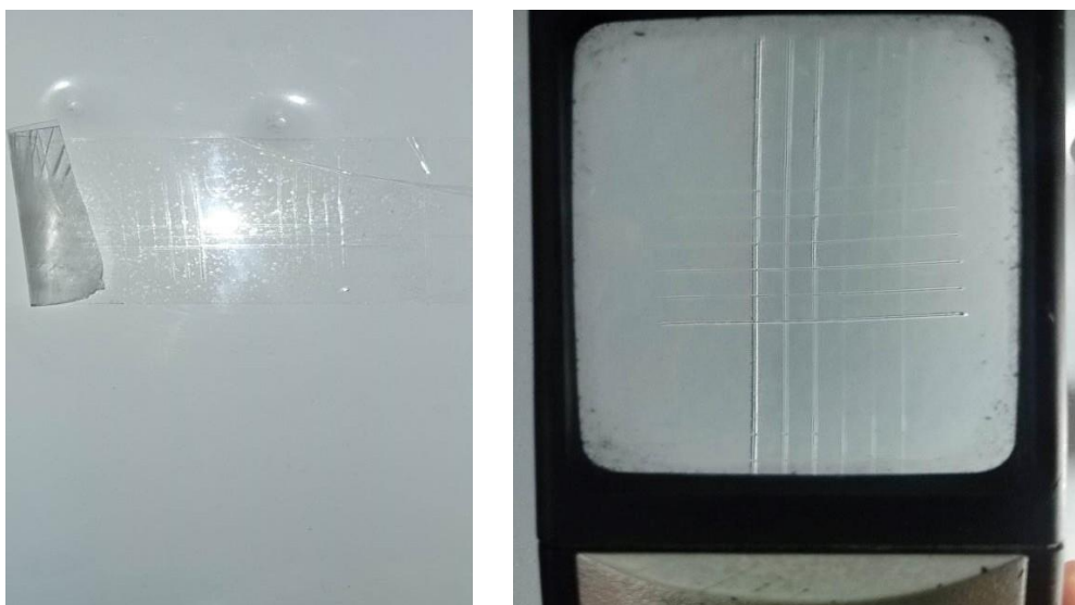
Figure 38: Pièce subit à un test de choc.
