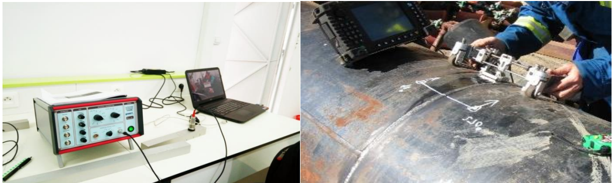
Figure 5 – Suivi des machines tournantes en fonctionnement par l'analyse ultrasonore.
