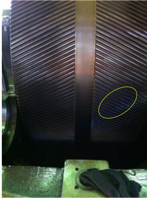
Figure 58 – Usure des dents d’engrenage.
