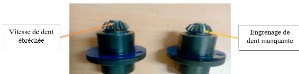
Figure 25 – Engrenages dentés ébréchés et manquants.
