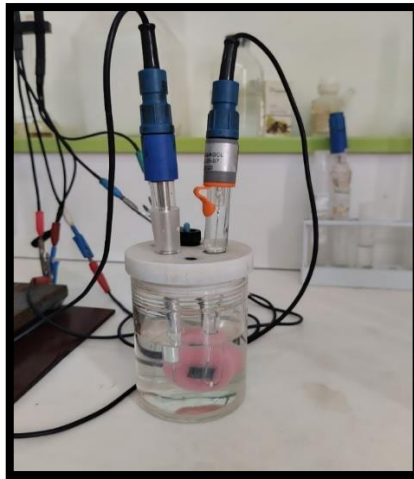
Figure III.13. Cellule électrochimique utilisée.
