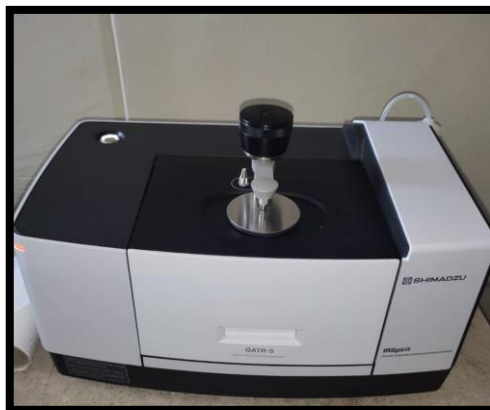
Figure III.14: Le spectromètre infrarouge (FTIR).
