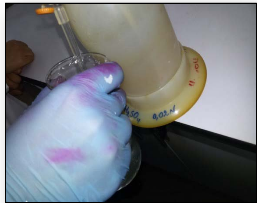
Figure IV.9 : Détermination de l'alcalinité t_a et t_{ac}
