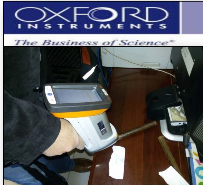
Figure IV.1 : détermination de la composition chimique par le PMI
