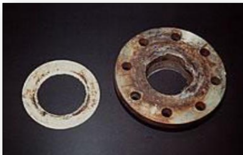
Figure III.5: la Corrosion caverneuse d'un acier allié sous un joint.
