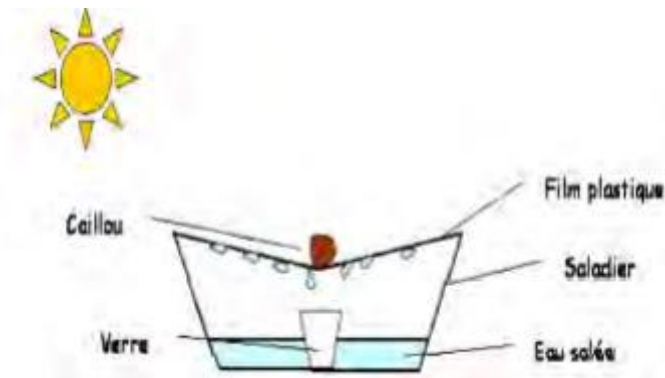
Figure I-9 : Distillateur solaire d'urgence[15]
