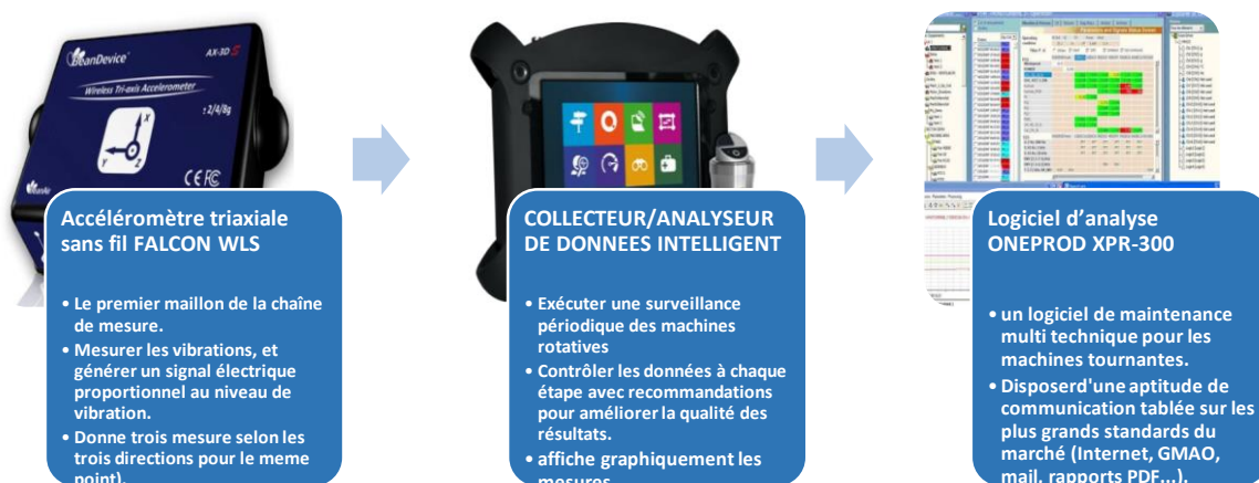
Figure 2.3 : Matériel utilisé pour le diagnostic de la chaîne de ventilation.
