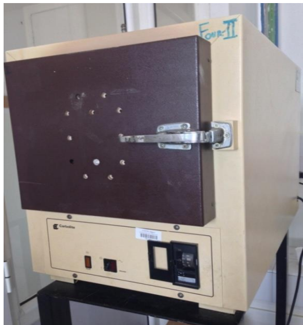
Figure II.5 Le four utilisé pour recuit.
