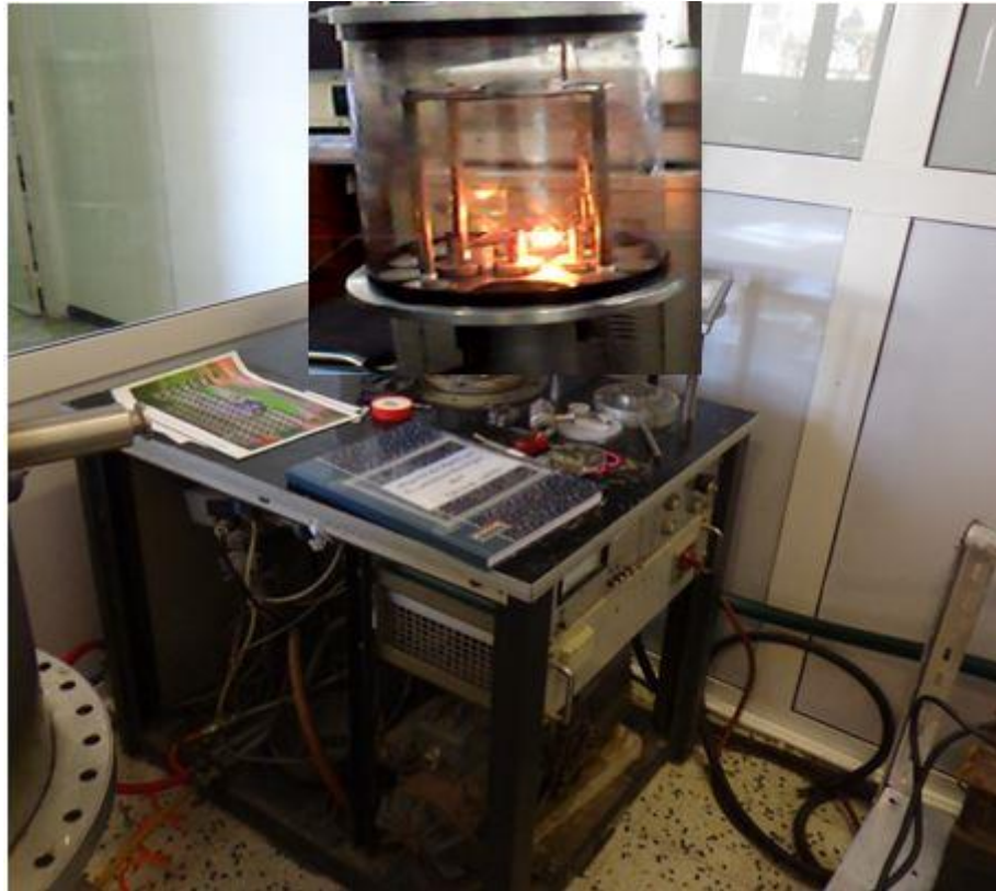
Figure II.3 Dispositif de l'évaporation sous vide par effet Joule.
