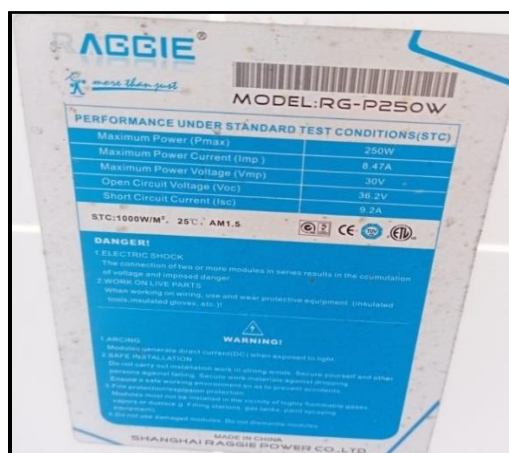
Figure IV.11: La plaque signalétique de panneau
