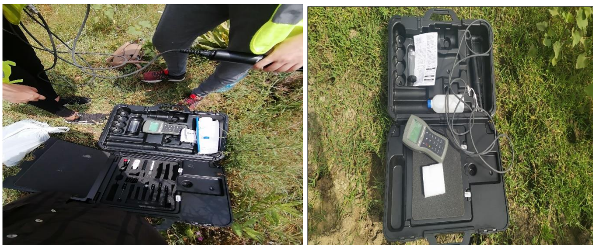
Figure 2. 1: Multiparamètre HI9829 et quelque paramètre insitu ( sortie du 06 juin 2021)
