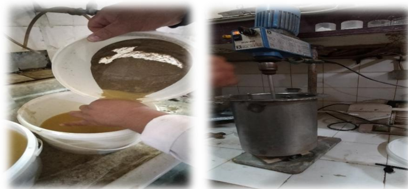
Figure (12) : Enrichissement par voie humide
