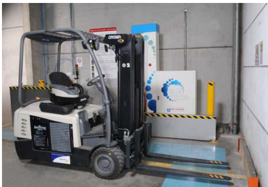
Chariot élévateur HyPulsion. Avec une puissance de 10 kW et de l'hydrogène stocké à 350 bar, le chariot a une autonomie de 8 heures et le plein d'hydrogène s'effectue en 3 minutes [2]
