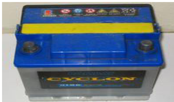
Fig.2.15 Une batterie à Plomb
