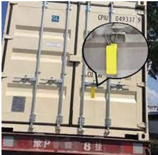
Figure 3.4. Positionnement d'une étiquette RFID passive sur la porte d'un conteneur
