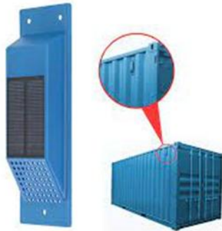
Figure 3.6. Dispositif GPS fixé sur la partie supérieure d'un conteneur pour assurer la visibilité satellite
