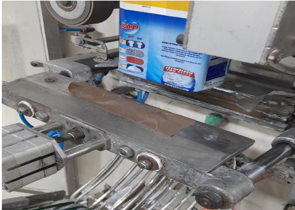
Figure 6: les barres de soudage horizontal et la lame de découpe de la DP300 lors de l'étape de scellage-découpe
