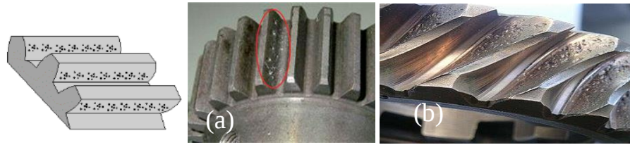
Fig 7. Dommages des dents par piqûres.
