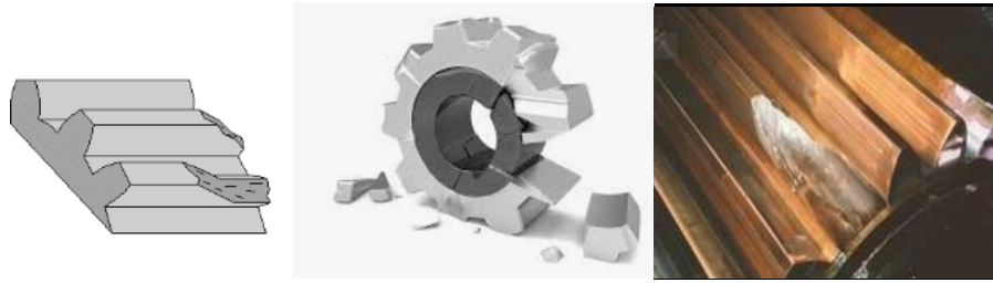
Fig 10. Cassures et fissures.
