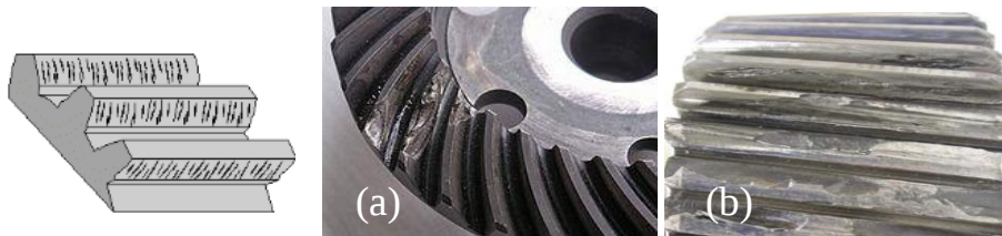
Fig 6. Usure des dents.
