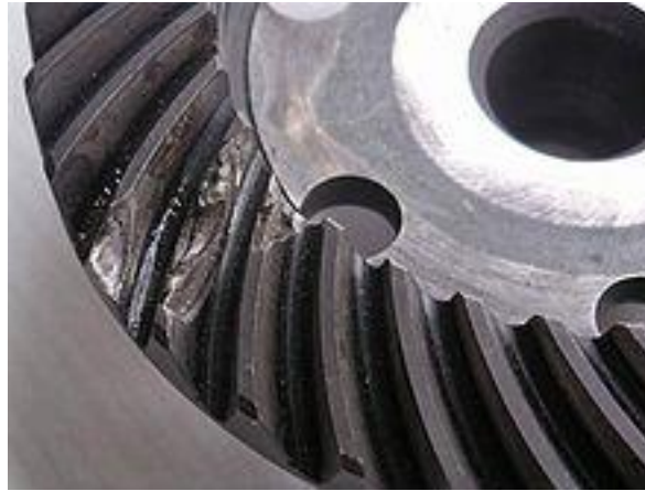
Figure I-11: Dégradation des dents d'une roue dentée
