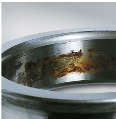
Figure I-14: Défaut d'écaillage de roulement
