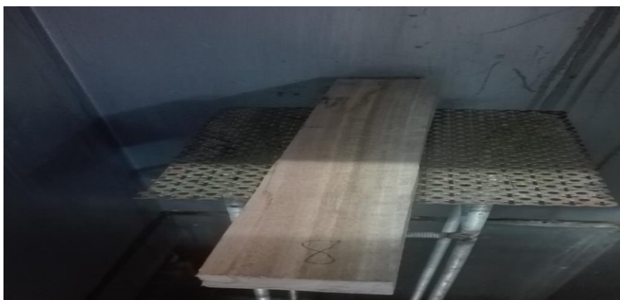
Figure V.6 Disposition de la planche dans la veine d'essai.
