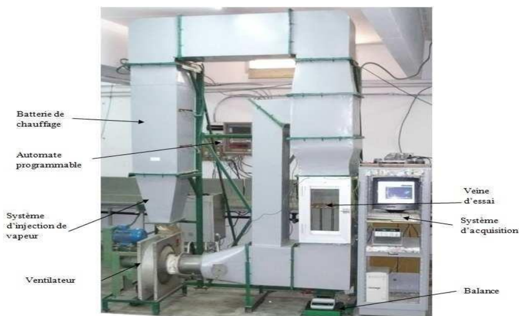
Figure I.1 Boucle de séchage du LETTM-FST.
