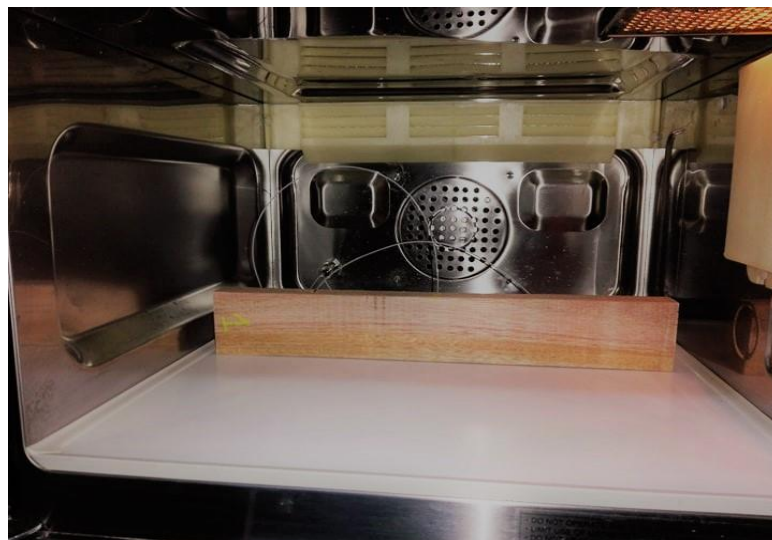
Figure VI.2 Echantillon de bois placé dans la cavité du four BP-301.
