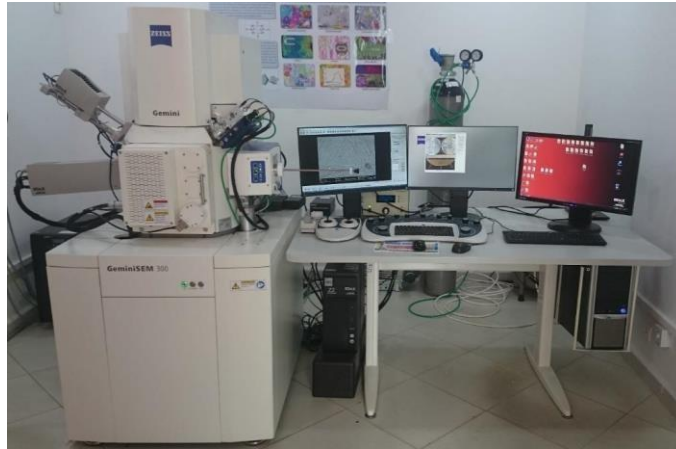
Figure II. 5: Dispositif expérimental de l'appareil du « MEB ZEISS® Gemini SEM 300 ».
