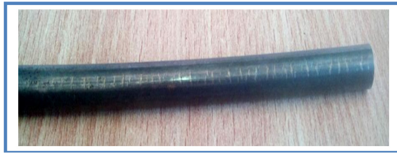
Figure III.6: L'échantillon tréfilé non conforme avec L'apparition des défauts à la surface.
