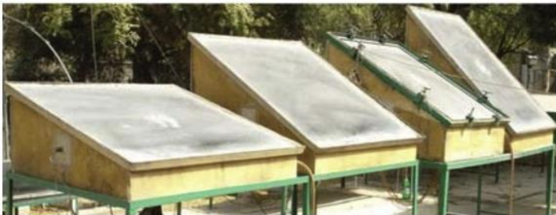
Figure. 5 Les distillateurs solaires passifs à pente unique de Dev et Tiwari avec un angle d'inclinaison de 15^\circ , 30^\circ , 30^\circ , 45^\circ de gauche à droite. Adapté avec la permission de la réf. [7].
