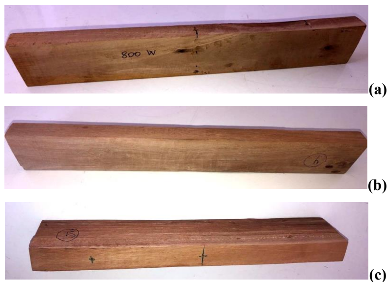
Figure IV.14 Influence du séchage intermittent sur le comportement final du bois séché sous différentes puissances de micro-ondes : (a) P =800W, (b) P =500W et (c) P =300W.
