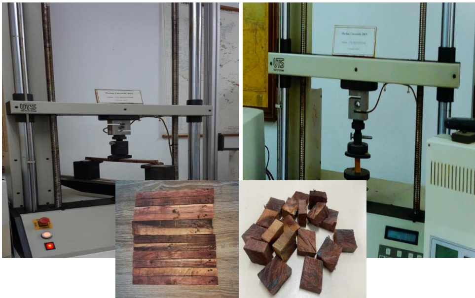
Figure IV.3 Appareil de test mécanique de flexion statique en trois points et de compression axiale.
