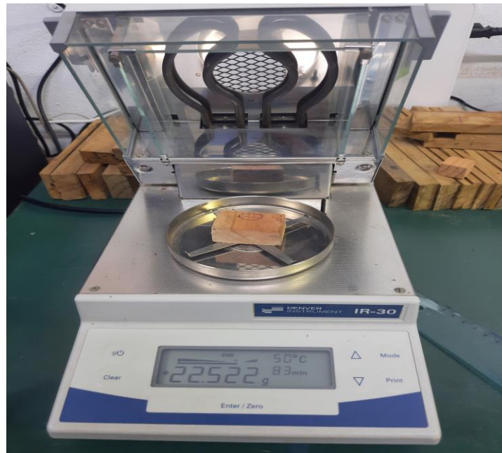
Figure III.13 Le dessiccateur pour l'étude du changement dimensionnel (LETTM-FST).
