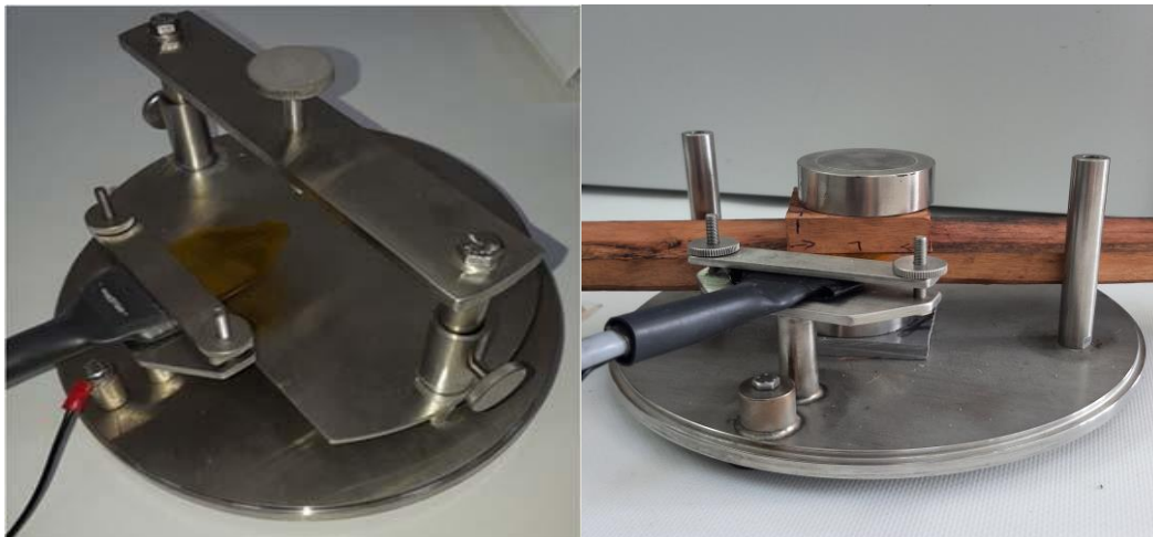
Figure III.15 Dispositif expérimental de la méthode Hot Disk (CRTEEn- Borj Cédria).
