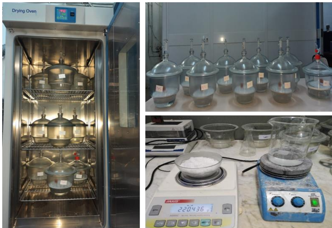
Figure III.2 Dispositif expérimental pour la mesure des isothermes de désorption (LETTM-FST).
