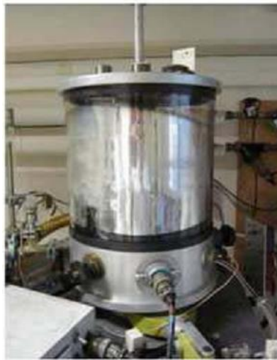
Figure A-8 : Bâti de l'évaporateur sous vide.
