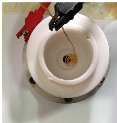
Figure II-2 : Image réelle de la cellule d'anodisation
