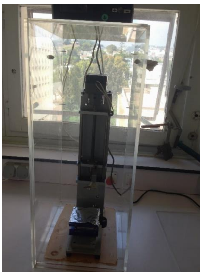
Figure II-9 : Equipement de déposition des couches minces par voie Sol-Gel « dip-Ccating ».
