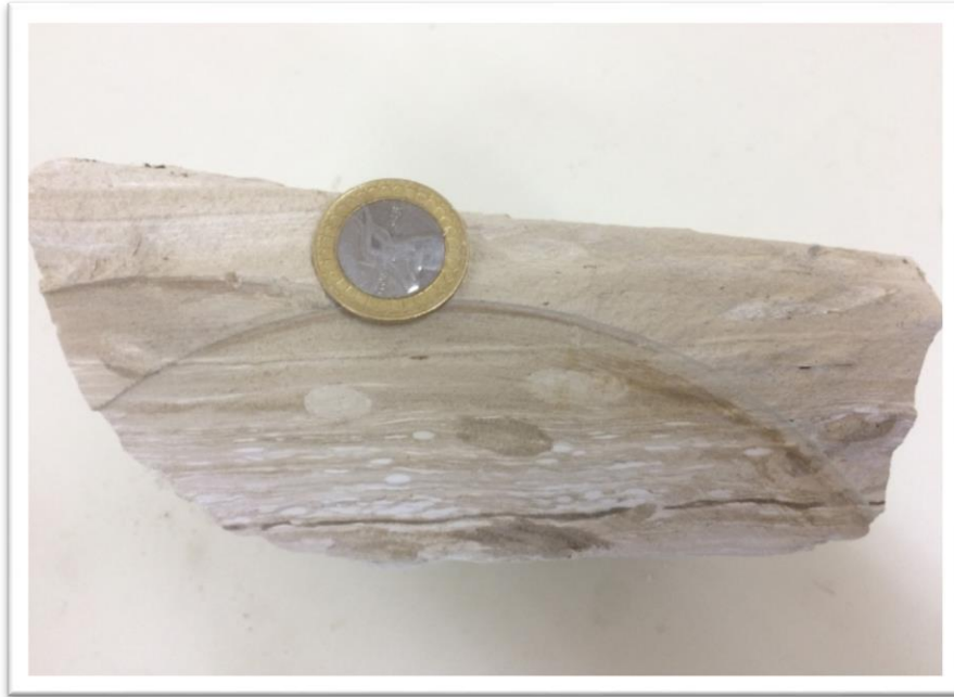
Figure I.2 : Diatomite litée de Sig à l'état brut (Boucherit Y & Boudemagh N, 2017).
