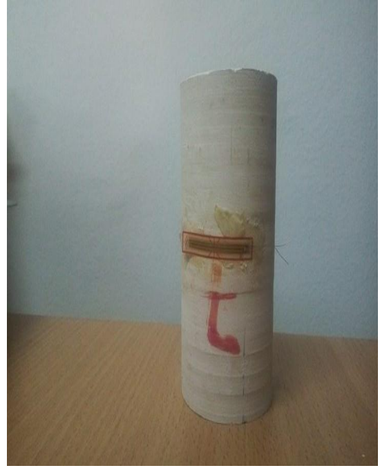
Les éprouvettes de diatomite avant l'essai uniaxial.
