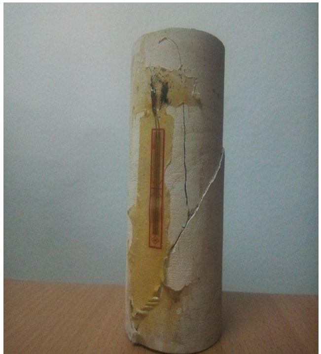
Les éprouvettes de diatomite après l'essai uniaxial
