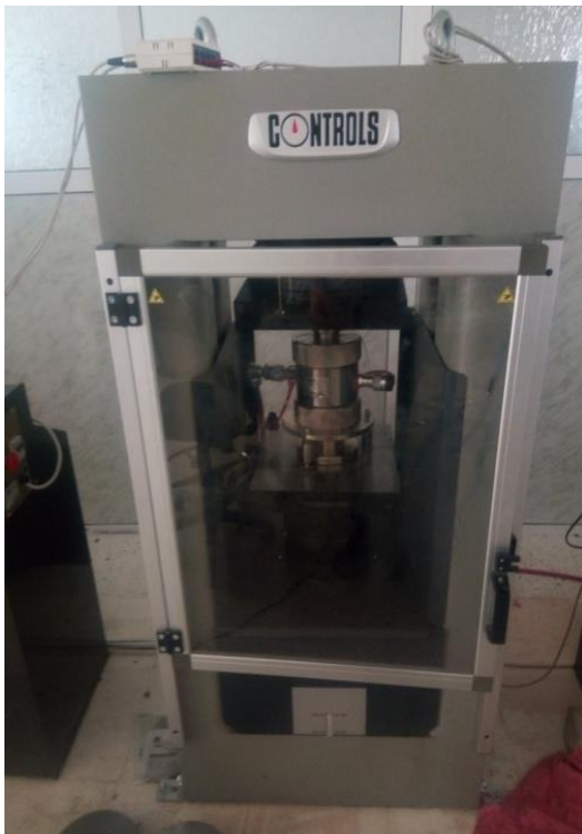
Figure IV.12 : Bâti de compression EN 4000 kN
