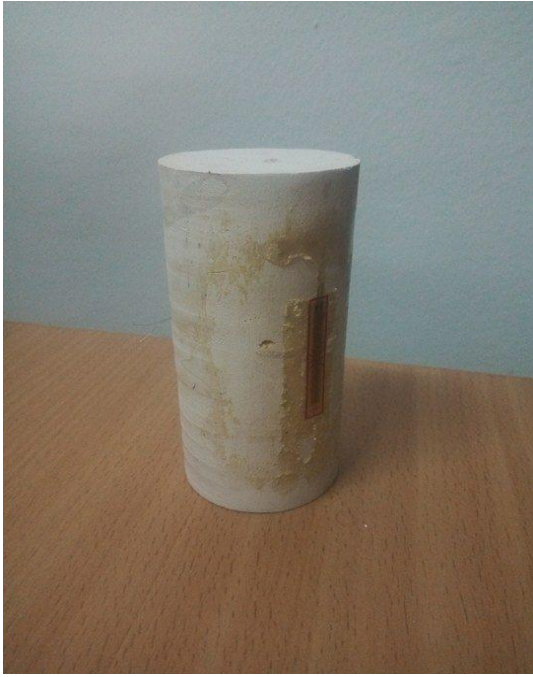
Les éprouvettes de diatomite avant l'essai uniaxial.
