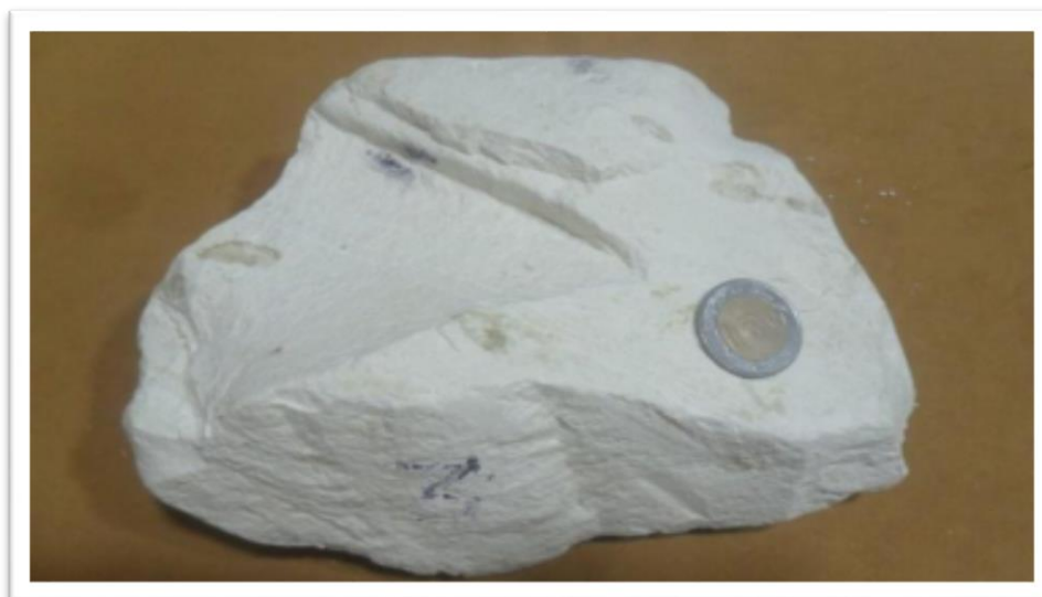
Figure I.1 : Diatomite massive de Sig à l'état brut (Boucherit Y & Boudemagh N, 2017).
