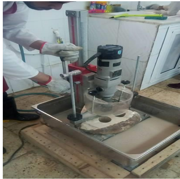
Figure IV.4 : Opération de carottage
