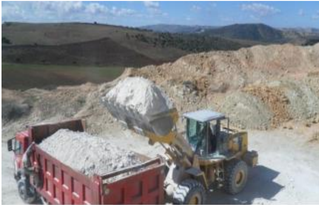
Figure III.14 : Opération de chargement de la diatomite de la zone de stockage.
