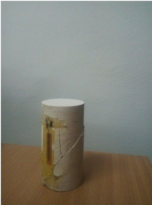
Les éprouvettes de diatomite après l'essai uniaxial
