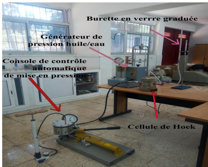
Figure IV.11: Appareillage de mesure de la perméabilité
