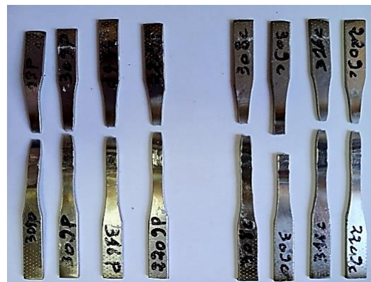
Figure.III.25. Eprouvette après la traction.
