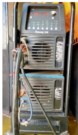
Figure.III.2. Poste de soudage TIG.
