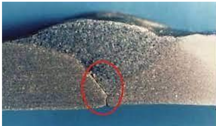
Figure II.12. manque de pénétration et collage en bord
