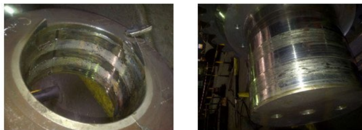
Figure 3 : Un palier endommagé [18]
