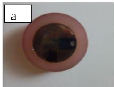
Figure.III.22 : les échantillons sont enrobés à froid (a : l'acier 42CD4 ; b : l'acier C45)
