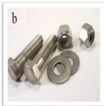
Figure.II.2 : Pièces en C45 (a : engrenages, b : boulonnerie, c : axe)
