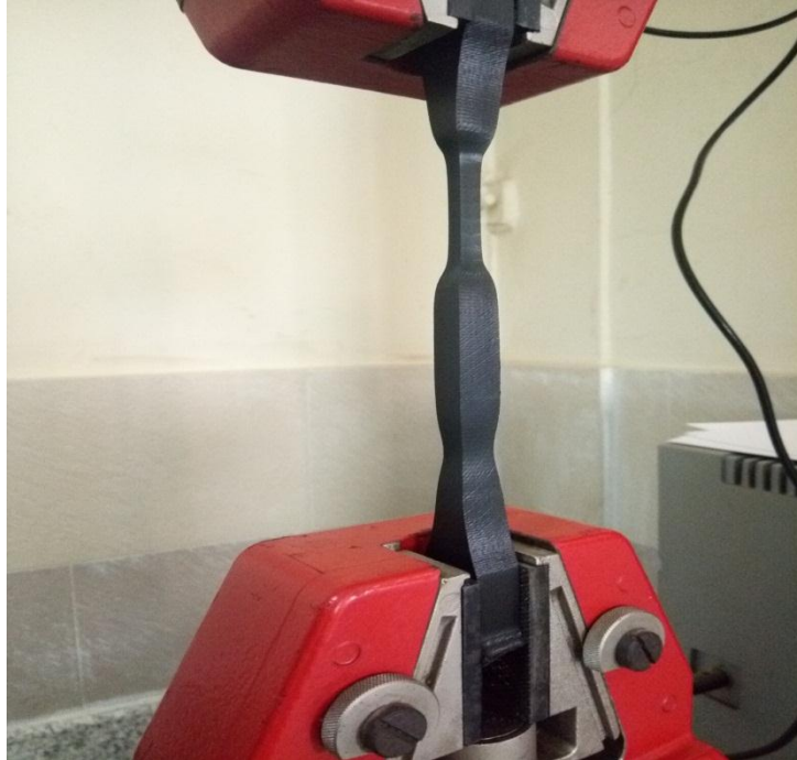
Figure III.14: éprouvette d'essai mise en place dans la machine de traction.
