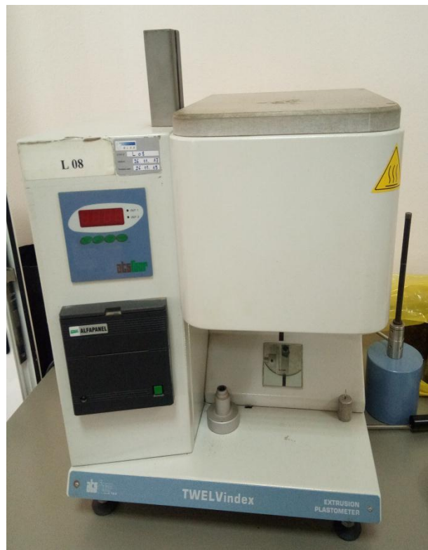
Figure II.1 : Appareillage type pour la détermination de l'indice de fluidité à chaud.
