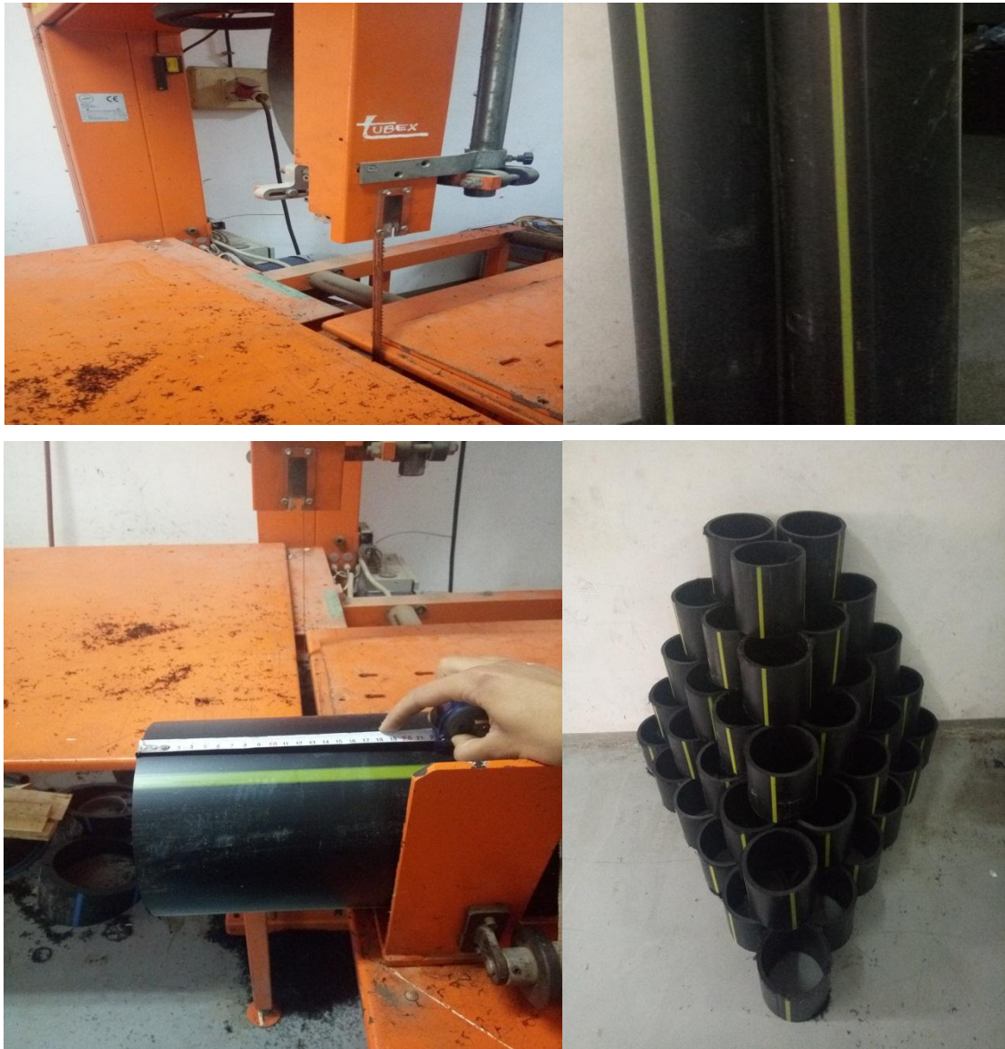
Figure III.6 : découpage des pipes en PEHD.
