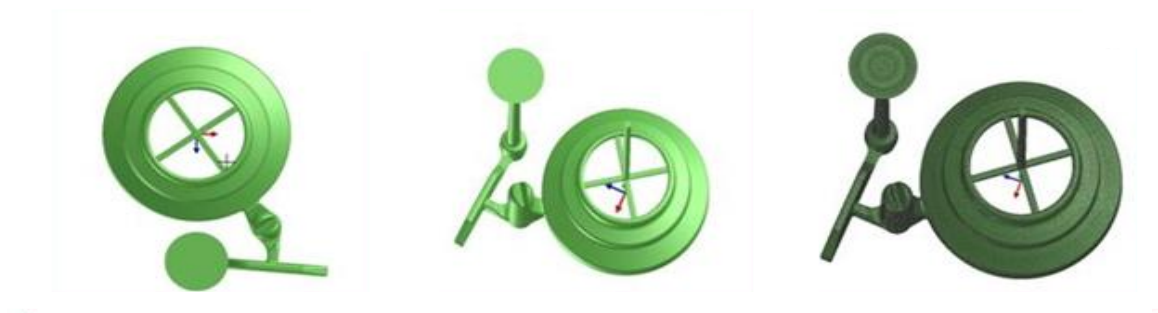
Fig. III.9 : Remplissage de l'empreinte du support de couronne ABS et du système de coulée
