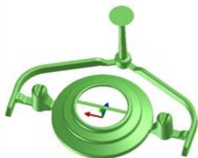
Fig. III.17 : Système de coulée et d'alimentation avant modification
