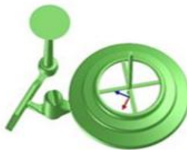
Fig. III.18 : Système de coulée et d'alimentation après modification
