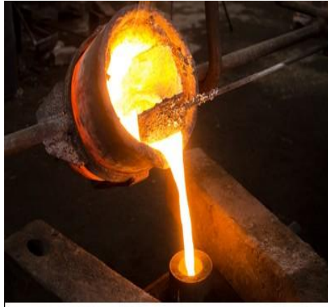
Fig. II.7 : Processus de coulé du métal
