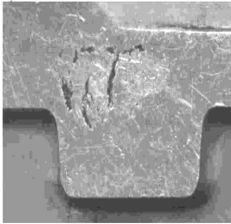
Fig. II.18 : Cricque apparente sur une pièce [30]
