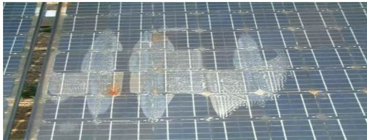
Figure II.2 : Dégradation du module photovoltaïque par délamination [11]
