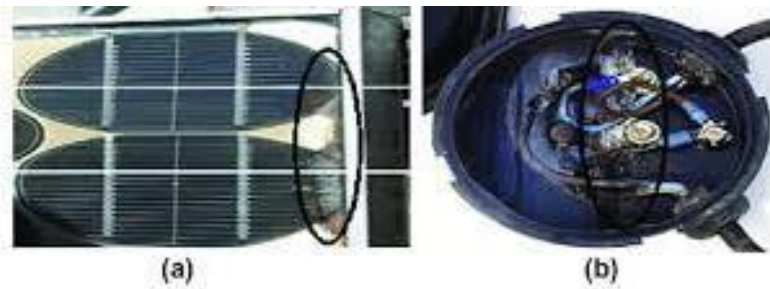
Figure II.2 : Dégradation du module photovoltaïque par délamination [11]
