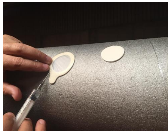
Fig. I. 6 : Appareillage de contrôle la contamination saline
