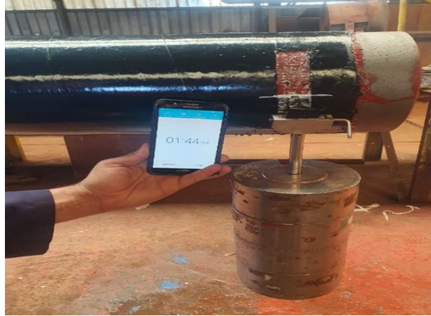
Fig.II. 5: L'arrachement de PE
