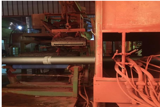
Fig. I. 5: Application de l'epoxy
