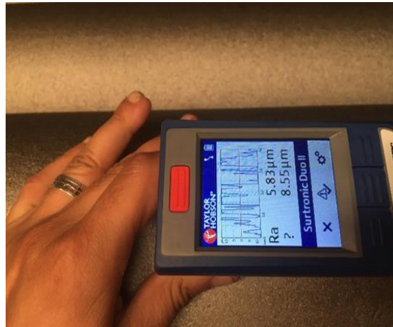
Fig. I.5: Test de rugosité
