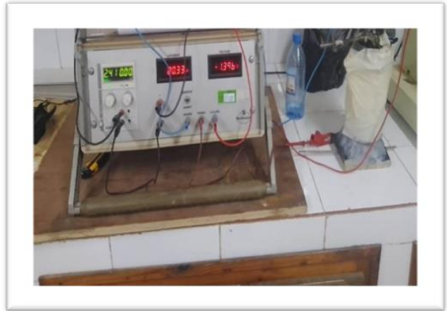
Fig. II. 2: Les équipements d'essai d'écoulement cathodique
