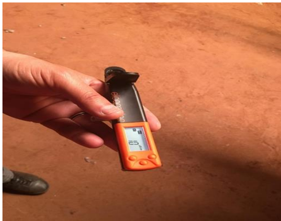
Fig. I. 6 : Appareillage de contrôle la contamination saline
