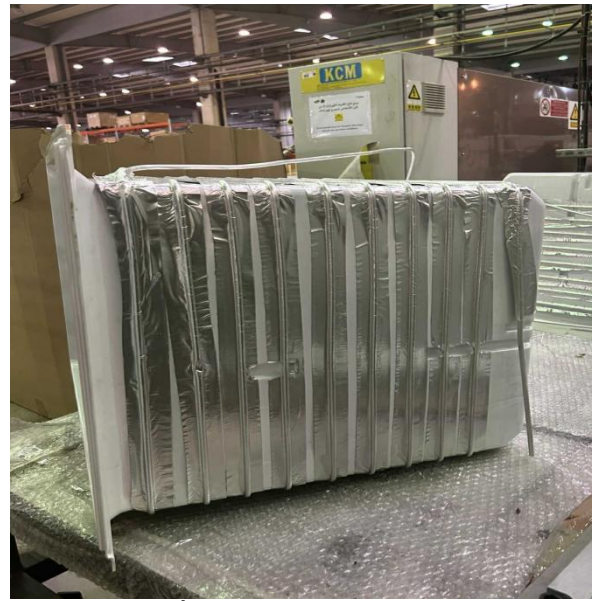
Figure 3.2. Évaporateur à géométrie à tubes enroulés
