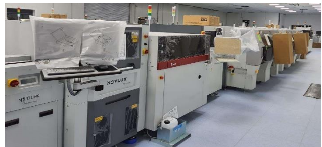
Fig III. 1 : (a) ligne d'assemblage SMD, (b) photo réelle de ligne.
