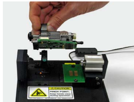
Fig IV. 3 : (a) l'interface de testeur de broches, (b) testeur de broches
