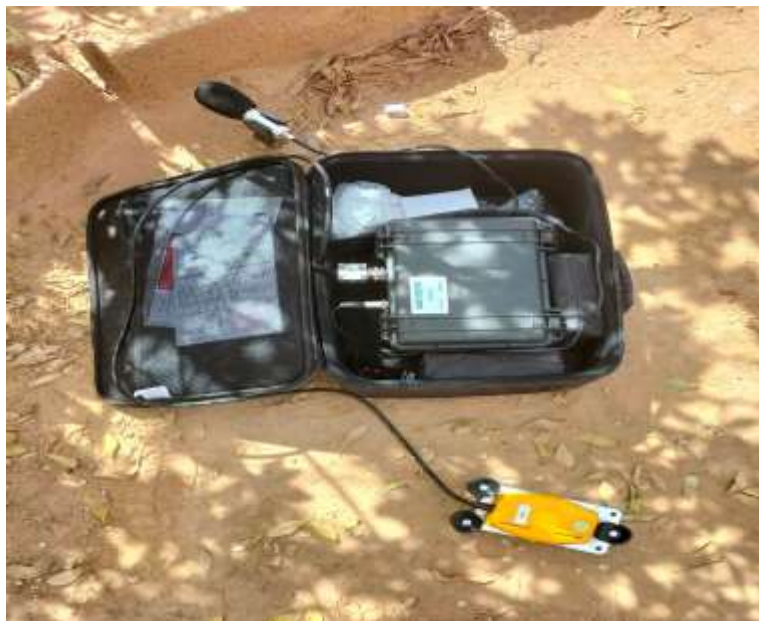
Fig IV.9 : Installation de sismographe sur site avant la procédure de tir
